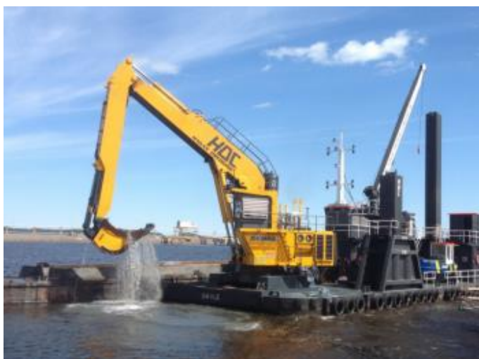
Figur 25. Exempel på enskopeverk. Bildkälla: hakandredging.se
